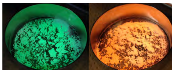
図 2 発光ベイポクロミズムを示すマンガン錯体
